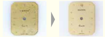
腐食した文字盤 リダン後
